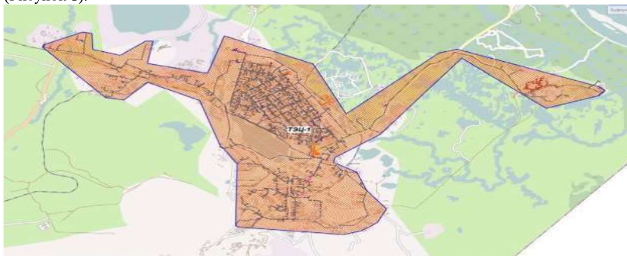
Рисунок 8 - Зона действия системы теплоснабжения ТЭЦ-1 Центрального района
