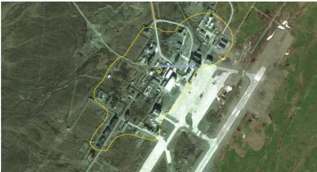
Рисунок 12 - Зона действия котельной аэропорта «Алыкель»
