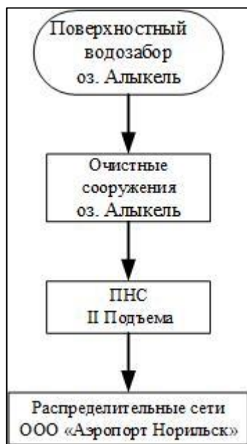
Рисунок 1.1.6 – Структурная схема централизованной системы питьевого водоснабжения ООО «Аэропорт «Норильск»
