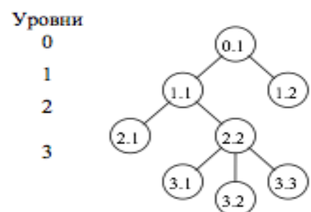
Рисунок 9. Пример - Граф структуры системы (И-дерево)
